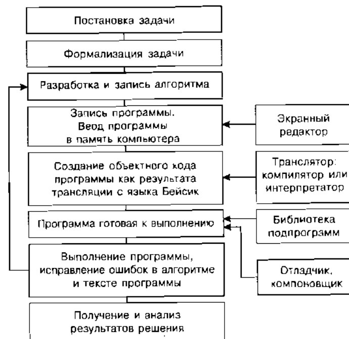
Рис. 4.2. Блок-схема этапов решения задач на компьютере
